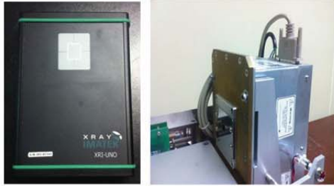
그림 1. 실험에 사용 된 X선 소스와 Medipix2 디텍터.
