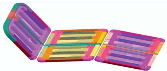
그림 4. 자세 변경시 공기압 튜브 시스템
