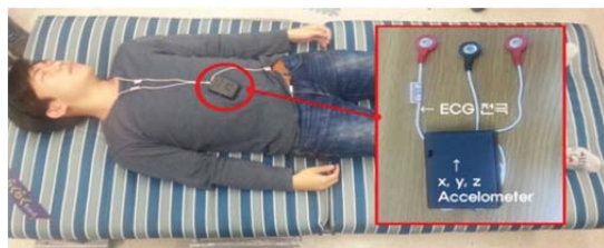
그림 1. ECG와 흉부의 움직임을 동시에 측정할 수 있는 휴대형 수면 검사기기와 이를 이용한 OSA 측정 모습.
